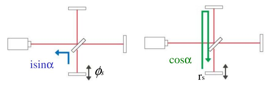
$l_{s} \approx \phi_{s} \times \text{transmittance of SRMI}$   $= \phi_{s} \times \left[ i \sin \alpha + i \sin \alpha \times r_{s} \cos \alpha + i \sin \alpha \times (r_{s} \cos \alpha)^{2} + ... \right]$   $= \phi_{s} \times \frac{i \sin \alpha}{1 - r_{s} \cos \alpha} \qquad \text{is is maximized when}$   $r_{s} = \cos \alpha$
